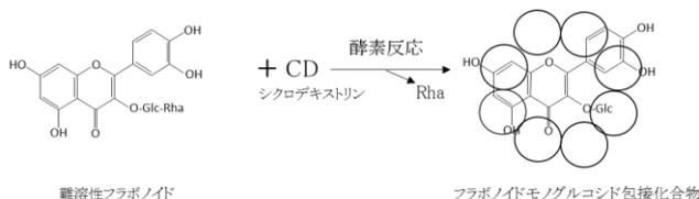
図1 フラボノイドモノグルコシド包接化合物の製造方法
