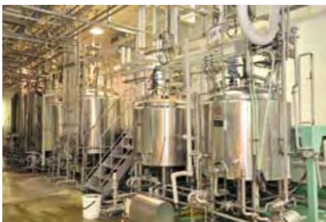
1000～3000リットルのタンクが並ぶ調合室。フレーバーが混ざらないように、アイテムによって別の部屋で調合されます
