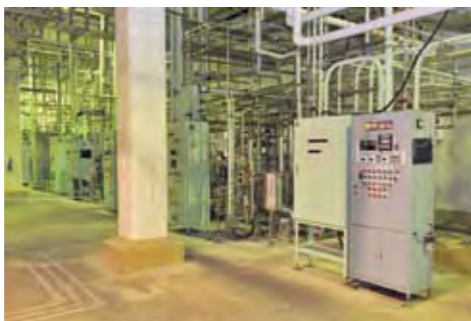
殺菌室には9台の殺菌機が並び、用途に応じて殺菌機を使い分けています。部屋の温度は常に40℃超え。とても暑いです
