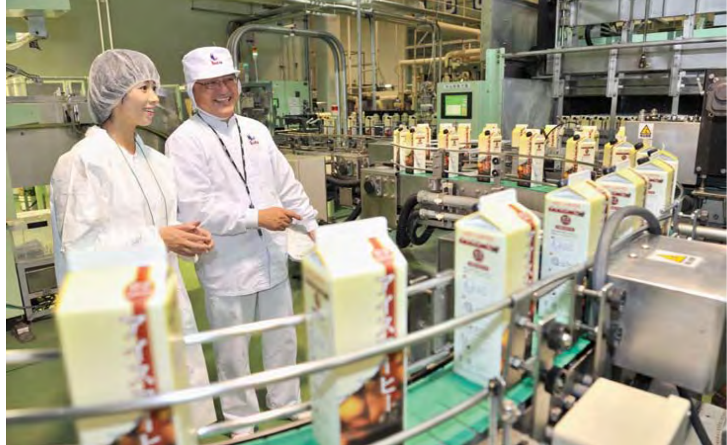
品質保証室の加藤さんに、工場内を案内していただきました。こちらの1リットル紙容器ライン（コーヒー専用）は1時間に4000本のコーヒーを生産することができます
