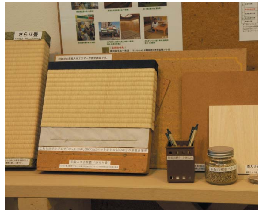
茶殻を木材と配合した茶配合ボードを畳の芯になる床材として採用した「さらり畳」の見本。六畳間分で、同社「お〜いお茶」500ml製品約3,600本分の茶殻がリサイクルできるという。その右に見えるのが、新開発の茶殻入り素材で作ったボールペン。右端が茶入りせっこうボード。
