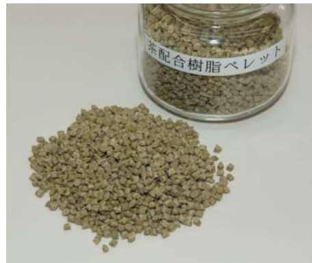
水を含んだままの茶殻をプラスチックに配合して作った茶殻配合樹脂ペレット。茶殻の持つ機能性を生かすため、表面になるべく茶殻が出るように配合方法が設計されている。鼻を近づけると、茶の香ばしい匂いがする。
